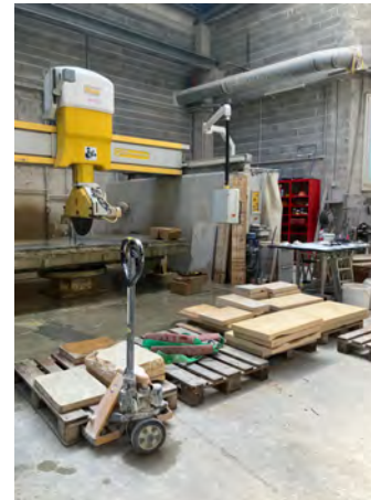
Halbierung der Steinplatten in der Dicke und Oberflächenbearbeitung im Steinwerk.
